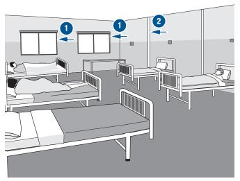
1 WINDOW PERIMETERS - Pecora Dynaflex or Pecora Dynaflex SC. 2 PANEL JOINTS - Pecora Dynaflex or Pecora Dynaflex SC.
