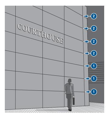
1 FOR JOINTS UP TO 10 FEET ABOVE GRADE - Pecora Dynaflex. 2 FOR JOINTS OVER 10 FEET ABOVE GRADE - Pecora Dynatrol II.
